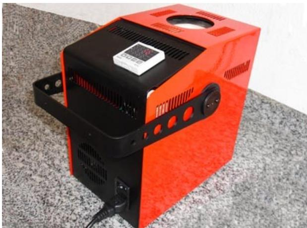
O Caldry 1200 é um calibrador de banho térmico seco desenvolvido para aferições de termopares, sondas e termômetros até 1200°C. Possui excelente estabilização e precisão, usando componentes de última geração isola a temperatura no poço com perfeição. É um instrumento indispensável tanto em laboratórios como em campo.
