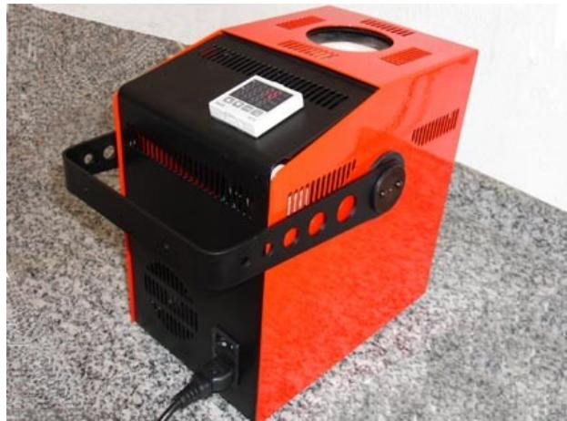
O Caldry 600 é um calibrador de banho térmico seco desenvolvido para aferições de termopares, sondas e termômetros até 600°C. Possui excelente estabilização e precisão, usando componentes de última geração isola a temperatura no poço com perfeição. É um instrumento indispensável tanto em laboratórios como em campo.
