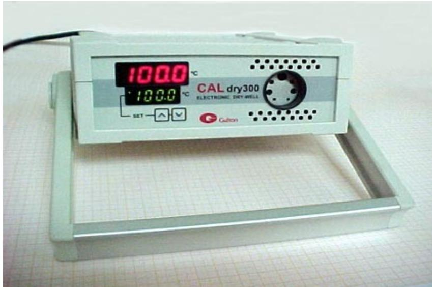
O calibrador Caldry 300 é indicado para testes e aferições de termopares, sondas e termômetros. Ele é muito fácil de usar, basta ligar e programar a temperatura desejada. Atinge a temperatura programada no bloco metálico com rapidez e excelente estabilização. É pequeno e leve facilitando a sua utilização tanto em bancadas de laboratórios como no campo. É disponível em duas versões de bloco, porém mediante consulta pode também ser pedido com blocos com furos diferentes.
