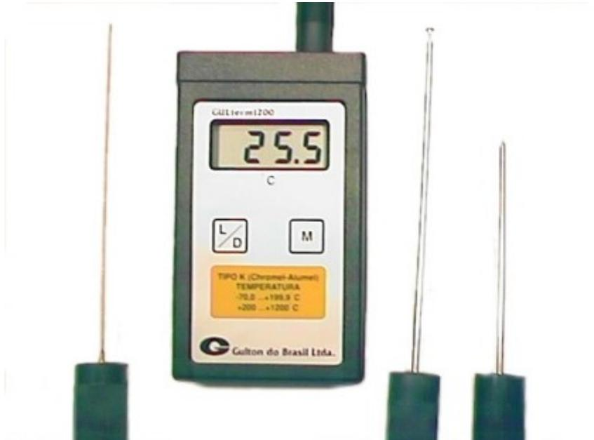
O termômetro Gulterm 1200 é um versátil aparelho destinado a medição de sinais oriundos de sondas que usam, termopar tipo K. Tem boa precisão e rapidez nas medições. Possui mudança automática de faixas de medição, permitindo sempre a melhor resolução do display. Tem ainda uma tecla M que congela a leitura
