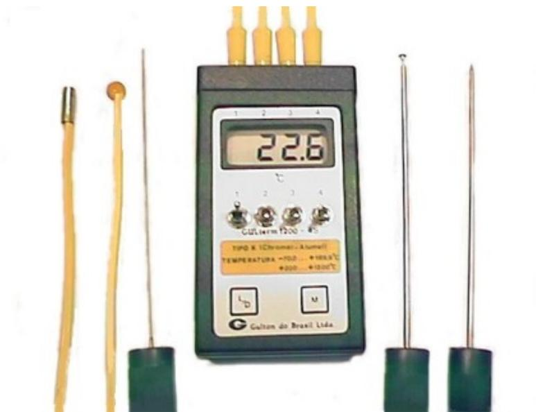
O termômetro Gulterm 1200-4S é um versátil aparelho destinado a medição de sinais oriundos de sondas que usam, termopar tipo K. Tem boa precisão e rapidez nas medições. Possui mudança automática de faixas de medição, permitindo sempre a melhor resolução do display. Tem ainda uma tecla M que congela a leitura.
