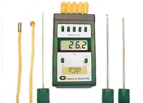
O termômetro Gulterm 1005 é um instrumento simples, prático, robusto e de baixo custo. É linearizado para termopares tipo K.
