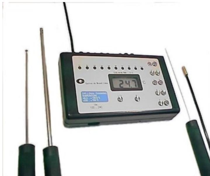
O termômetro Gulterm 700-10S é um versátil aparelho destinado a medição de sinais oriundos de sondas que usam, termopar tipo J. Tem boa precisão e rapidez nas medições. Possui mudança automática de faixas de medição, permitindo sempre a melhor resolução do display. Tem ainda uma tecla M que congela a leitura.
