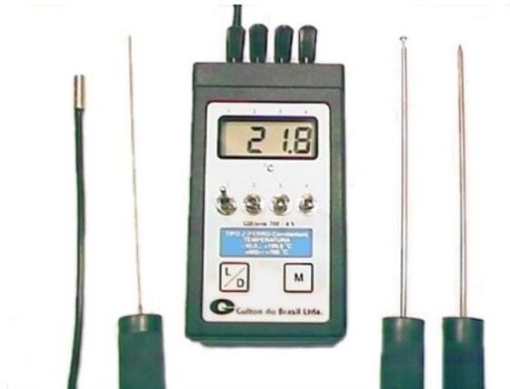
O termômetro Gulterm 700-4S é um versátil aparelho destinado a medição de sinais oriundos de sondas que usam, termopar tipo J. Tem boa precisão e rapidez nas medições. Possui mudança automática de faixas de medição, permitindo sempre a melhor resolução do display. Tem ainda uma tecla M que congela a leitura.
