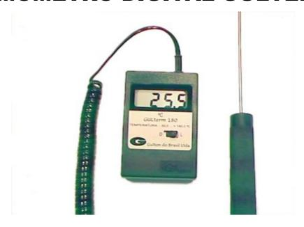
O Termômetro digital Gulterm 180 é um instrumento compacto , robusto e muito sensível à variações de temperatura.
